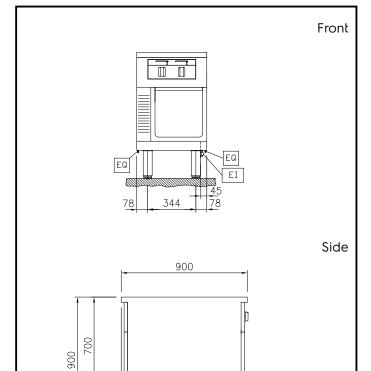
Electrical inlet (power) EQ **Equipotential screw**
